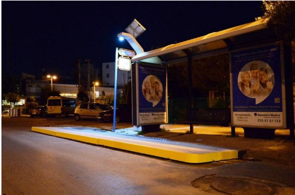
Εικόνα 17: Προεξοχές εισόδου σε όχημα δημόσιας συγκοινωνίας (πηγή: https://www.grtimes.gr/ )
